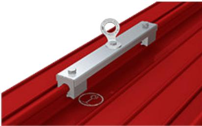
Avec son œillet en libre rotation, le point d'ancrage ABS-Lock Falz V pour joints arrondis assure la liberté de mouvement sur une toiture métallique. Cette protection antichute est fixée par des mâchoires spéciales en aluminium sans perforation sur un joint arrondi (par ex. BEMO, etc.).
